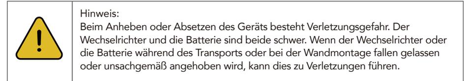
Das Heben und Transportieren des Wechselrichters und des Batteriespeichers muss von mehr als 2 Personen durchgeführt werden.
